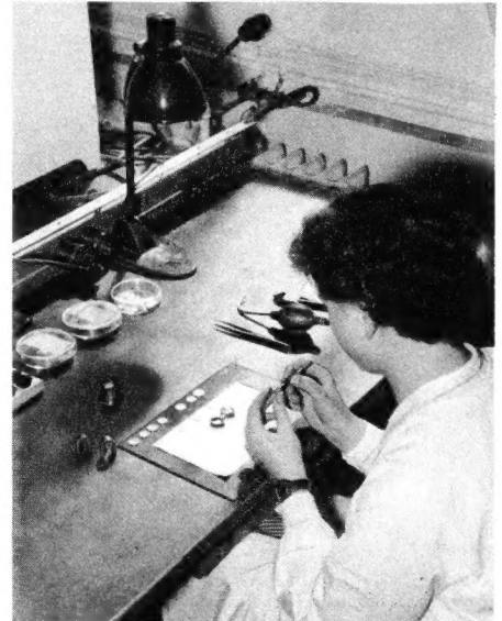
Bild 1. Die Montage der Quarzplättchen in den Telefunken-Laboratorien ist feinste Handarbeit. Jede Verunreinigung durch Staub oder Fett beim Einbau stört die Genauigkeit
