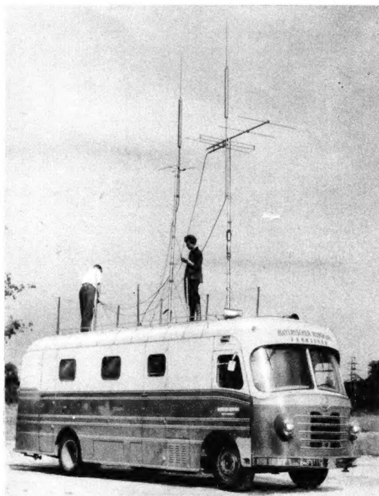
Bild 1. Fernseh-Übertragungswagen des Bayerischen Rundfunks. Auf dem Dach befinden sich der Dipol-Richtstrahler für die Tonübertragung, zwei Vertikal-Stabantennen für eine Funksprechanlage und eine weitere Dipol-Antenne zum Empfang des Kontrollbildes
