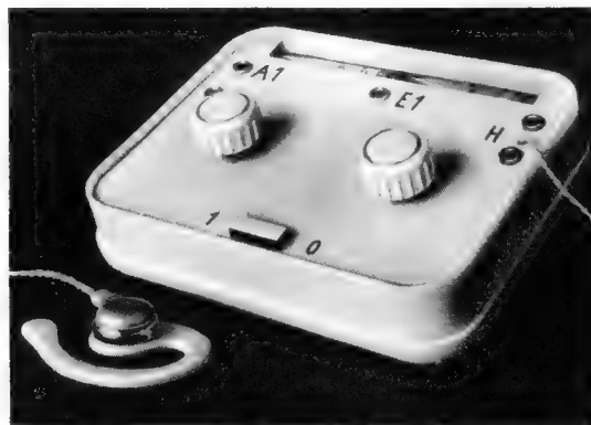
Bild 1. Transistor-Empfänger E 551. An der Oberkante erkennt man die beiden Batterien, links die Antennenbuchsen, rechts die Kopfhörerschur und zwei zusätzliche Hörerbuchsen, in der Mitte die beiden Drehknöpfe für die Abstimmkondensatoren und vorn den Griff für einen Schiebeschalter
